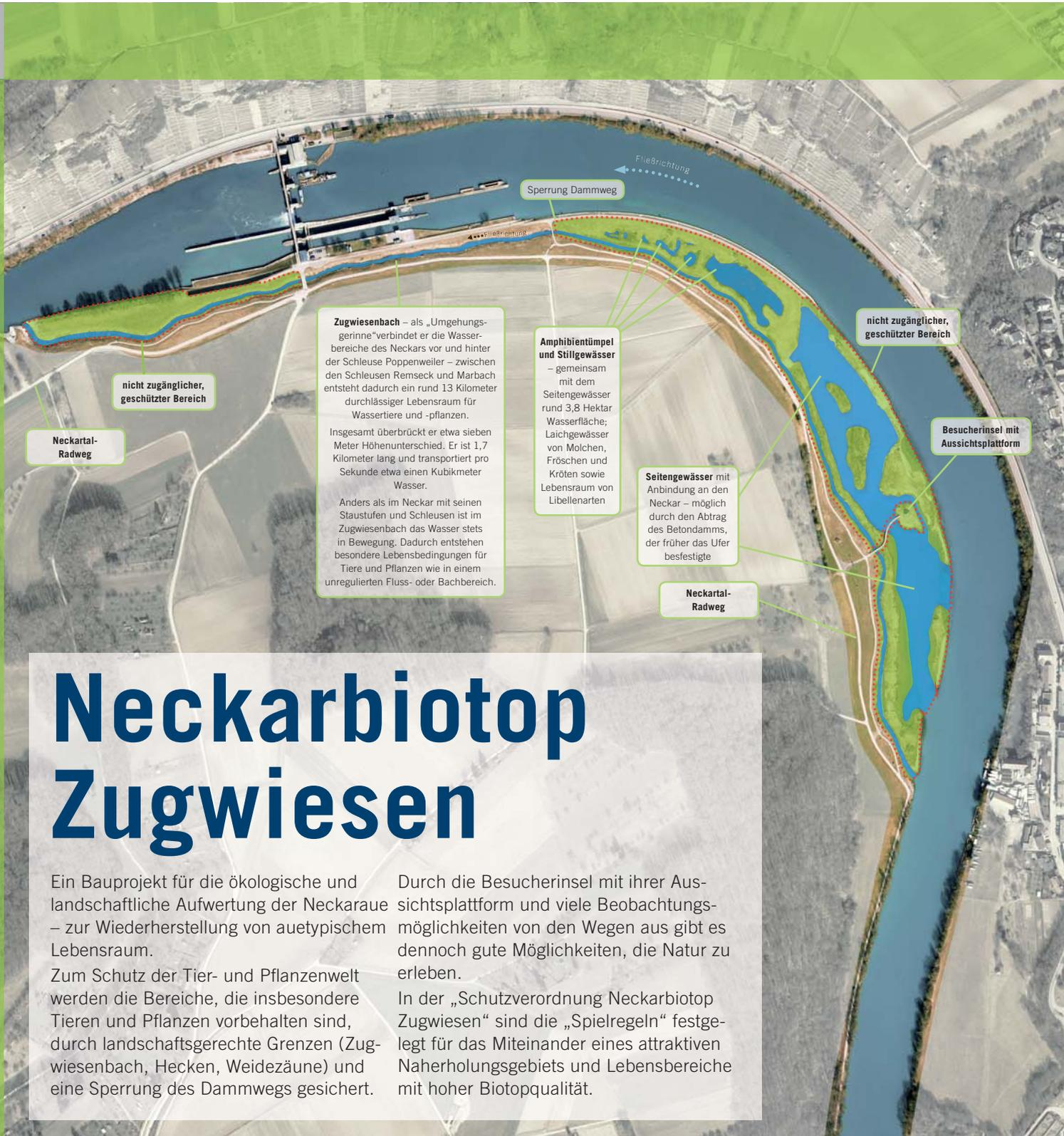
**Zugwiesenbach** – als „Umgehungsgerinne“ verbindet er die Wasserbereiche des Neckars vor und hinter der Schleuse Poppenweiler – zwischen den Schleusen Remseck und Marbach entsteht dadurch ein rund 13 Kilometer durchlässiger Lebensraum für Wassertiere und -pflanzen.
